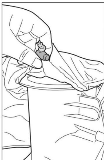
Navlíkněte filtrační sáček přes horní část bazénového vysavače (viz.obr.). Ujistěte se, že šňůra sáčku je umístěna pod přírubou horní části bazénového vysavače.
