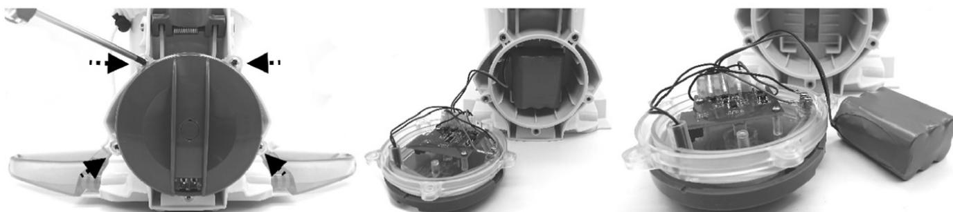
2. Pro odpojení přípojovacího kabelu baterie, zatlačte na sponu konektoru a vytáhněte jej. POZNÁMKA: Konektor ihned omotejte izolační páskou, aby nedošlo ke zkratu způsobenému kontaktem obou svorek vodičů.
