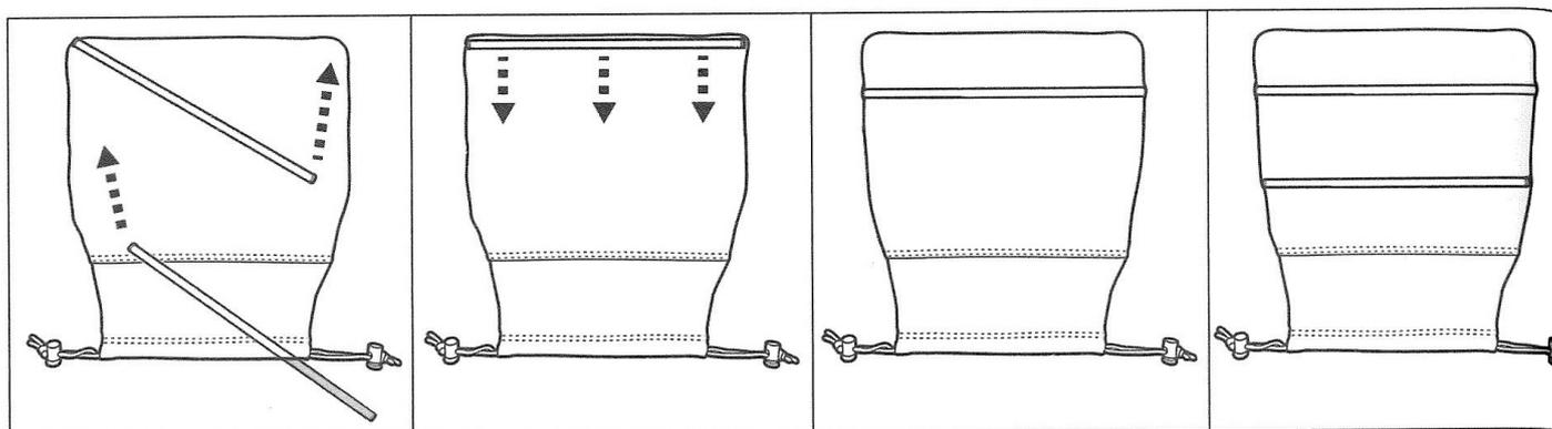
Upevněte filtrační sáček na jemný kal tak, aby delší strany sáčku směřovaly k bočnímu rozšíření vysavače, jak je znázorněno na obrázku. Ujistěte se, že filtrační sáček je zcela upevněný přes horní lem otvoru vysavače a upevňovací šňůrka nepřekáží pohybu držáku teleskopické tyče (viz obrázek níže).
