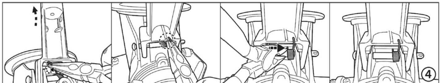
4. Pomocí kleští vytáhněte háček pružiny ze spodní části držáku do horní části držáku a poté jej připevněte podle obrázku. Posuňte celou pružinu doprava.
