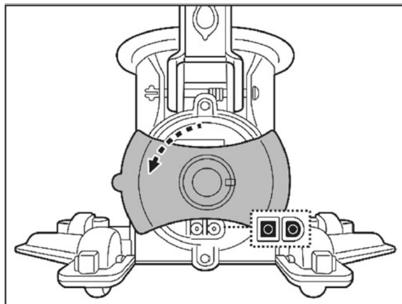
2. Připojte nabíjecí kabel k nabíjecímu portu.
