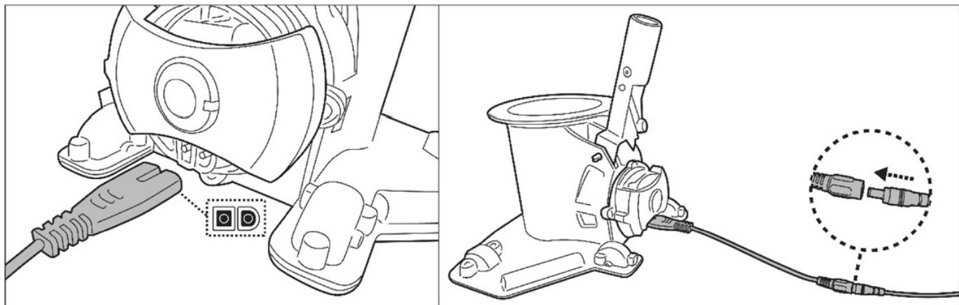
3. Připojte externí adaptér ke zdroji napájení. Kontrolka na externím adaptéru se rozsvítí červeně, když se vysavač nabíjí a zeleně, když je nabítý. Pro nejlepší výkon jej nabíjejte 5-6 hodin.
