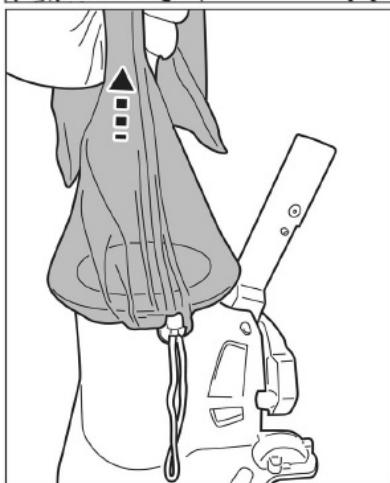
Před vložením bazénového vysavače do vody lehce zvedněte vysavač za filtrační sáček vak, abyste se ujistili, že je filtrační sáček dostatečně upevněný.
