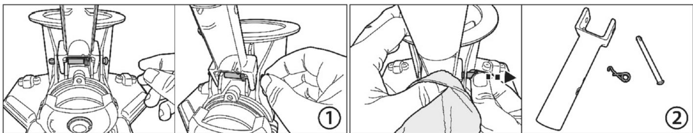
1. Uchopte horní kulatý konec plastového čepu. V případě potřeby si pomozte kleštěmi.
