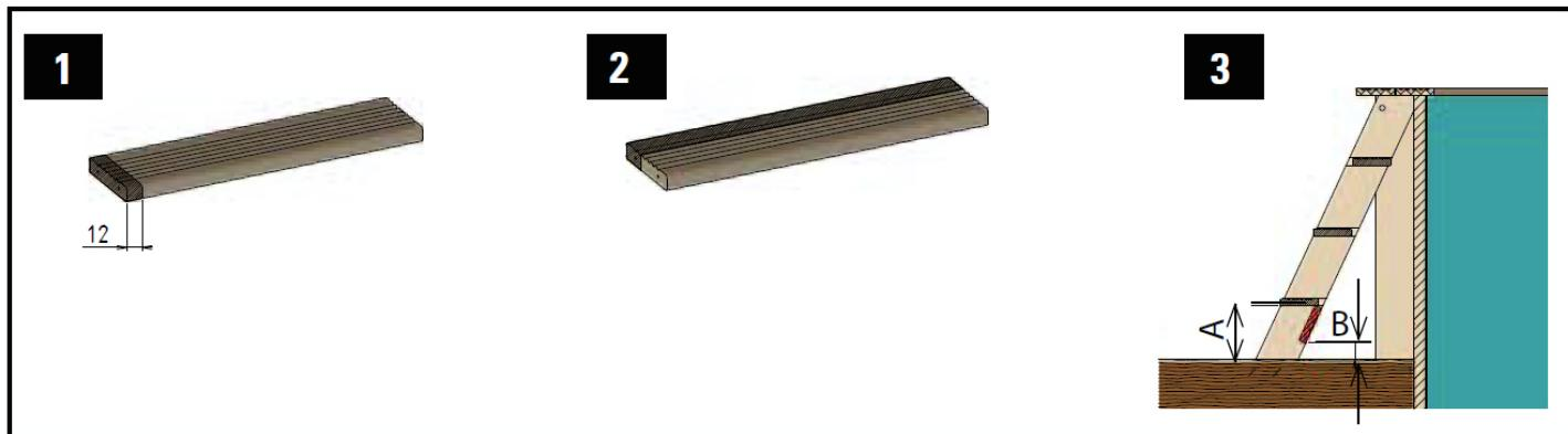
V případě, že bazén je částečně zapuštěn v zemi, měly by se schůdky zaříznout, aby se přizpůsobily bazénu. Z bezpečnostních důvodů, pokud je prostor mezi podlahou a prvním schodem mezi 80 a 230 mm (rozměr A), uzavřete tento prostor pomocí schodnice od schůdků, kterou jste vybrali, takže rozměr B je menší než 89 mm. Postupujte takto:
