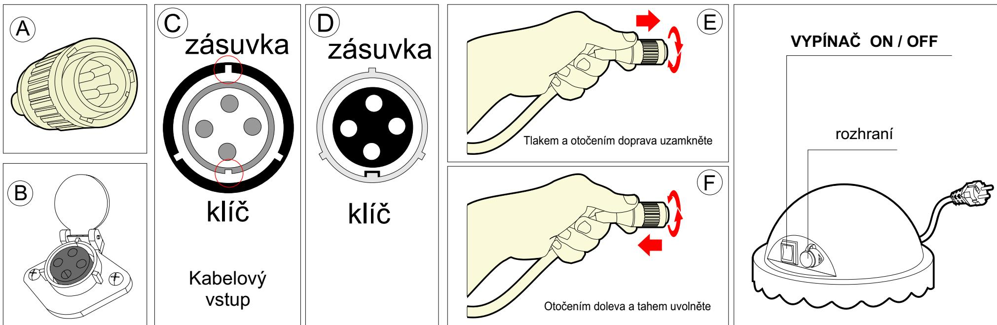
Pro zapojení kabelu (obr. A) do zásuvky na napájení,(obr. B) prosím udělejte následující:
