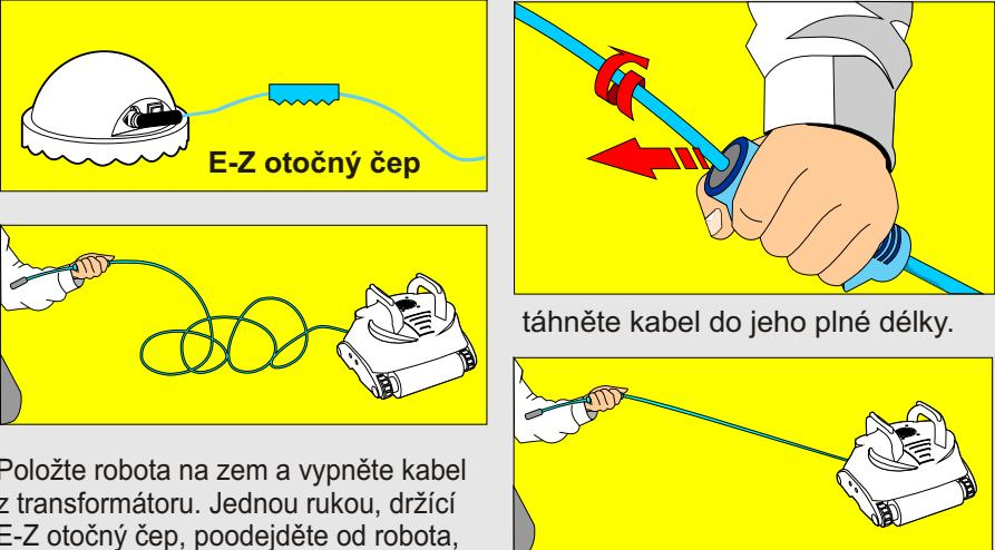
Položte robota na zem a vypněte kabel z transformátoru. Jednou rukou, držící E-Z otočný čep, poodejděte od robota, táhněte kabel do jeho plné délky. Střed se bude točit uvnitř krytu a tímto způsobem rozmotáte kabel.
